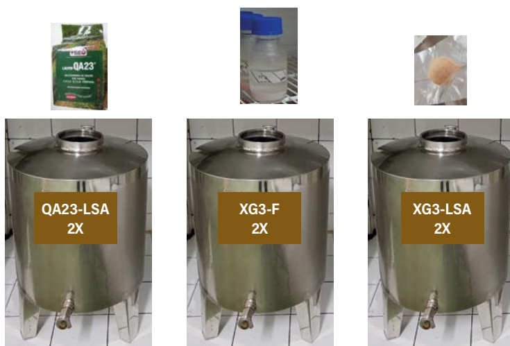
Figura 3. Ensaíos de microvinificación na Evega para comparar un lévedo comercial (QA23-LSA) con XG3 como cultivo fresco (XG3-F) e en forma seco activa (XG3-LSA).
